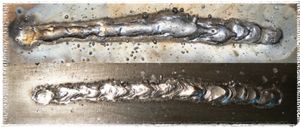
Rys.4 Widok napoiwy przed i po oddzieleniu żużla
